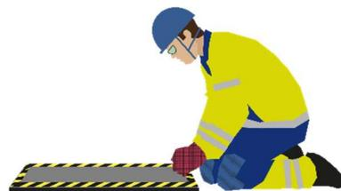
Se o trabalho vai ser feito sobre travamentos de vigas que cobrem o solo, este deve ser ancorado e marcado. O material que vai cobrir a abertura deve ter capacidade para suportar a carga a que vai ser exposto.
