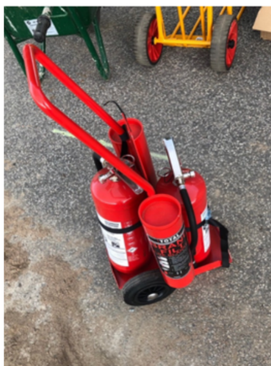
Vagn för släckutrustning underlättar arbetet.
