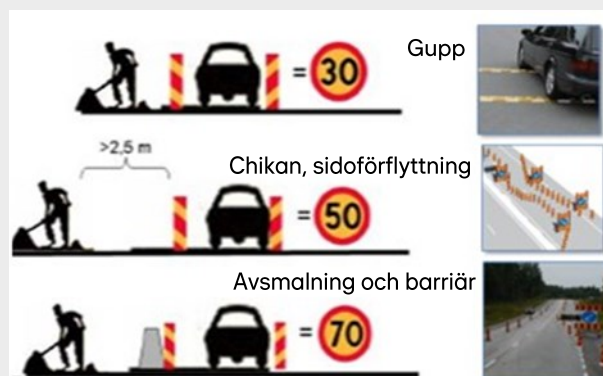
Exempel på fysiska anordningar för att sänka hastigheten
