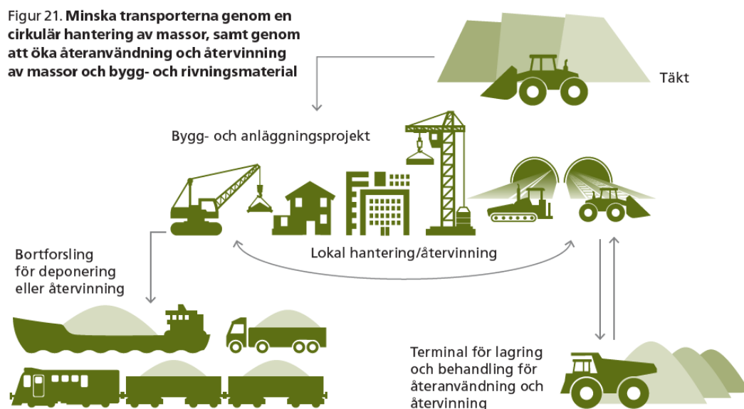
Figur 1.3.1 Utdrag från RUFSS 2050, schematisk bild gällande flöde av överskottsmassor från bygg- och anläggningsprojekt.
